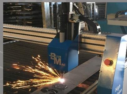
Alta precisión en movimientos y desplazamientos de los 3 ejes, gracias a la alta calidad de las guías prismáticas y de los 4 servomotores instalados.
